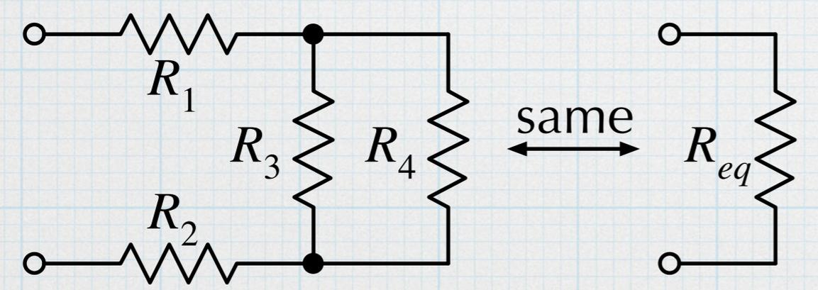
$$R_{eq} = R_1 + R_2 + R_3 \parallel R_4$$
