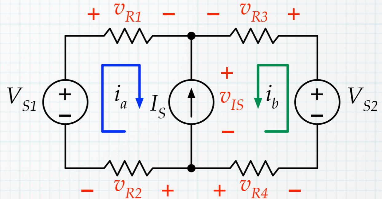
a:  $V_{S1} - v_{R1} - v_{IS} - v_{R2} = 0.$
