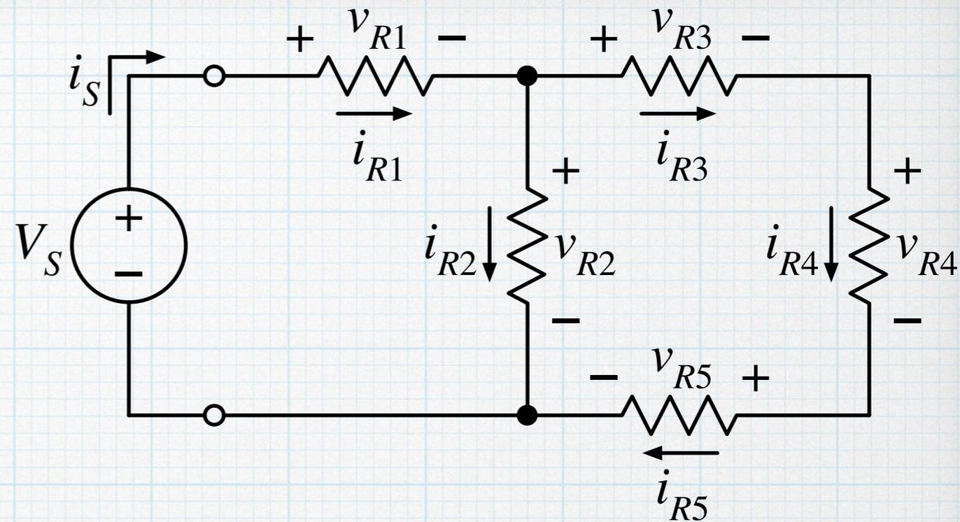
$$\text{KCL: } i_{R1} = i_{R2} + i_{R3} ; i_{R3} = i_{R4} = i_{R5}.$$
