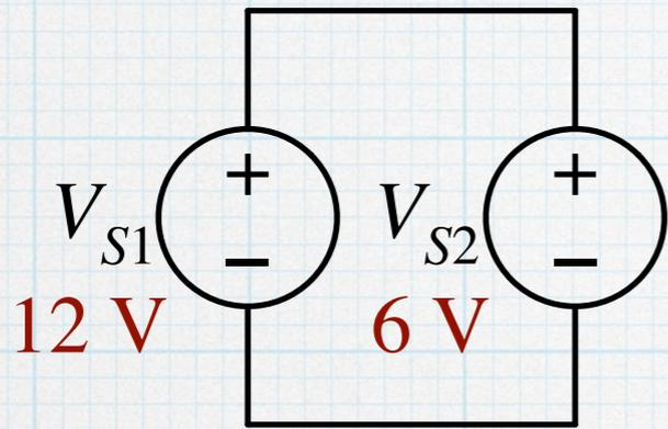
KVL:  $V_{S1} - V_{S2} = 6 \text{ V} \neq 0!!$  Yikes!
