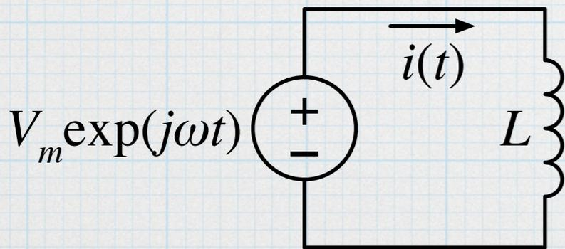
$$i_L(t) = \frac{1}{L} \int V_m e^{j\omega t} dt = \frac{v_L(t)}{j\omega L}$$
